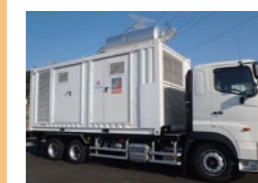
可搬型ポンプ
