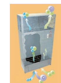
PAR (静的水素再結合装置)
